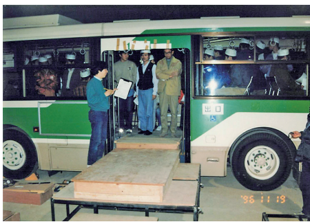
写真1：バスの乗降性評価実験
